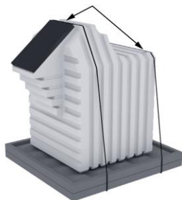
Místo instalace napínačů
